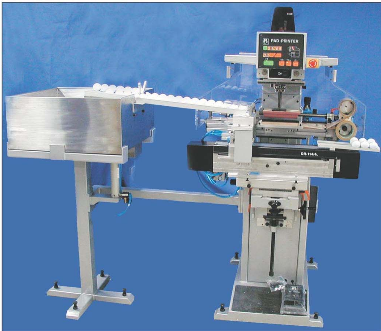
PP-150 横行油杯系统 360° 滚动印刷 ( 高尔夫球 ) PP-150 SCMIC 360° Roller Print (Golf Ball)
