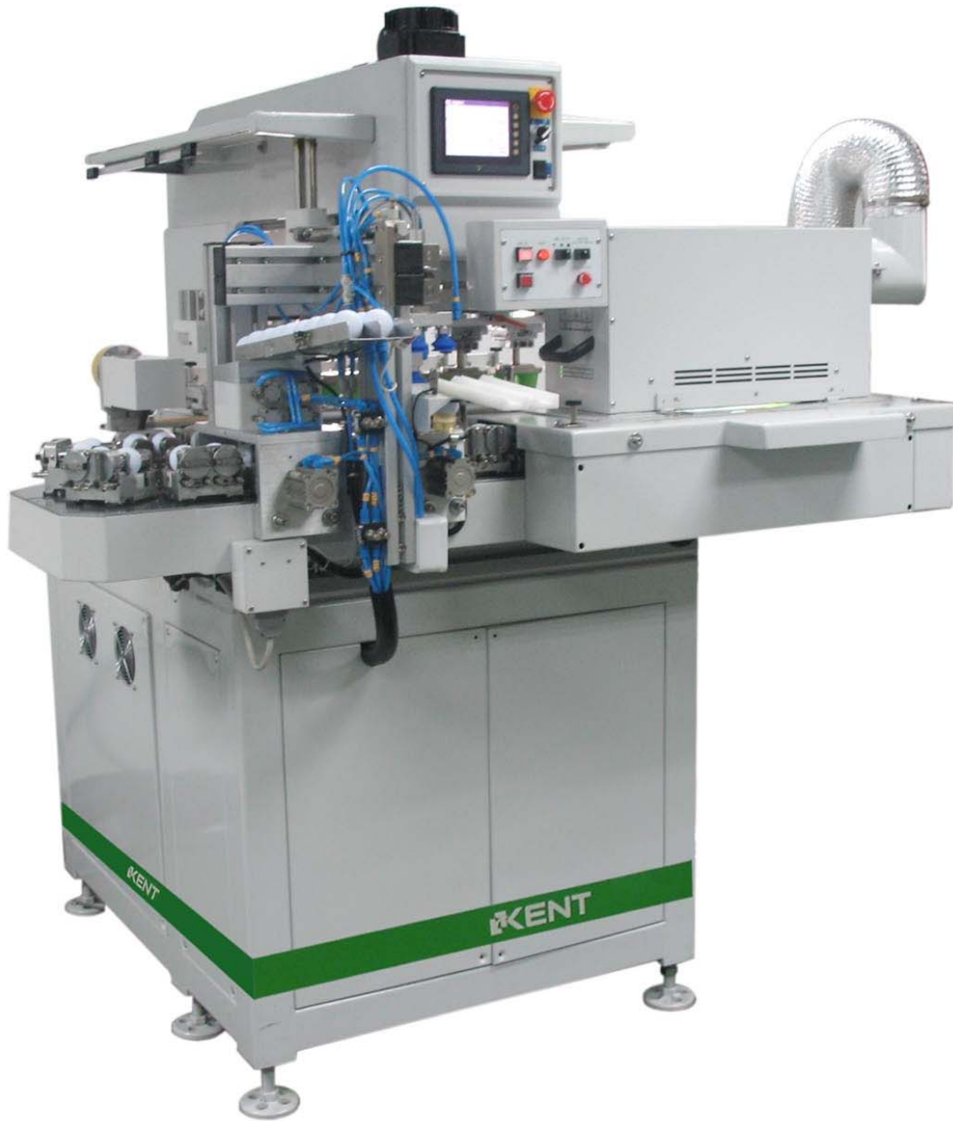
全自动 6 色 UV 移印系统 ( 高尔夫球商标印刷 ) Full Auto 6 colors UV Pad Printing System(Trademark Logo Print)
