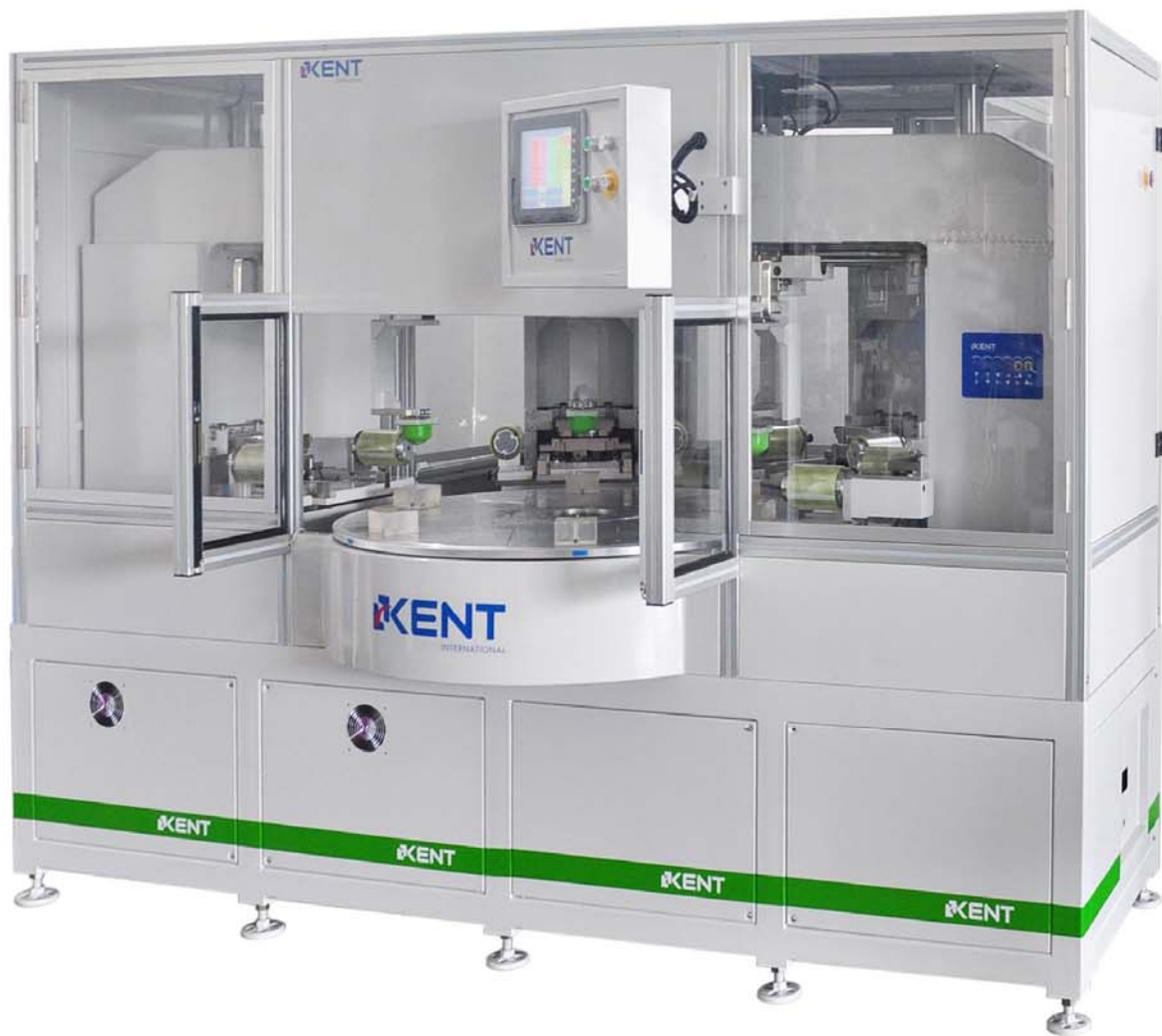
自动化移印系统（三菱电饭锅内胆） Full Auto Pad Printing System (Mitsubishi Rice cooker Inner Container)
