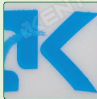
传统胶头 - 胶头变形问题 Print distortion
